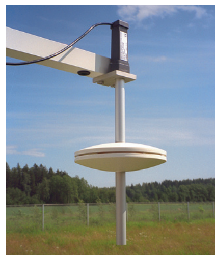
PTB210 w parze z głowicą ciśnienia statycznego SPH10.
